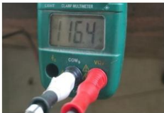
Figura A3. Detalle de lectura instantánea con pinza voltamperimétrica.
